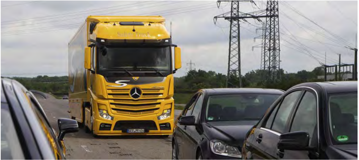
Der neue »Active Brake Assist 3« leitet nun auch vor stehenden Hindernissen selbsttätig eine Vollbremsung ein.
